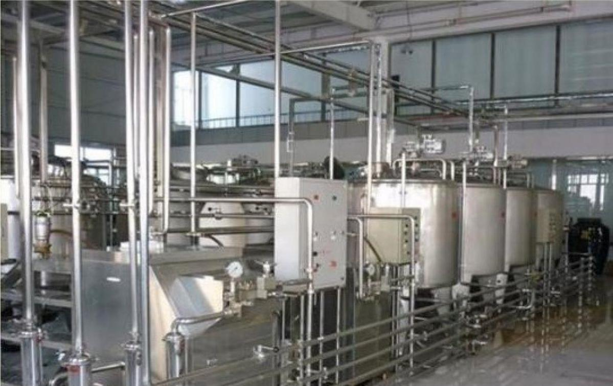
Abb. 5: Pasteurizer TETRA PAK Multitube in der Produktionshalle
