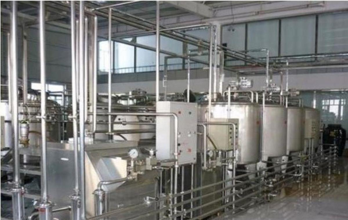
Abb. 14: Pasteurizer TETRA PAK Multitube in der Produktionshalle
