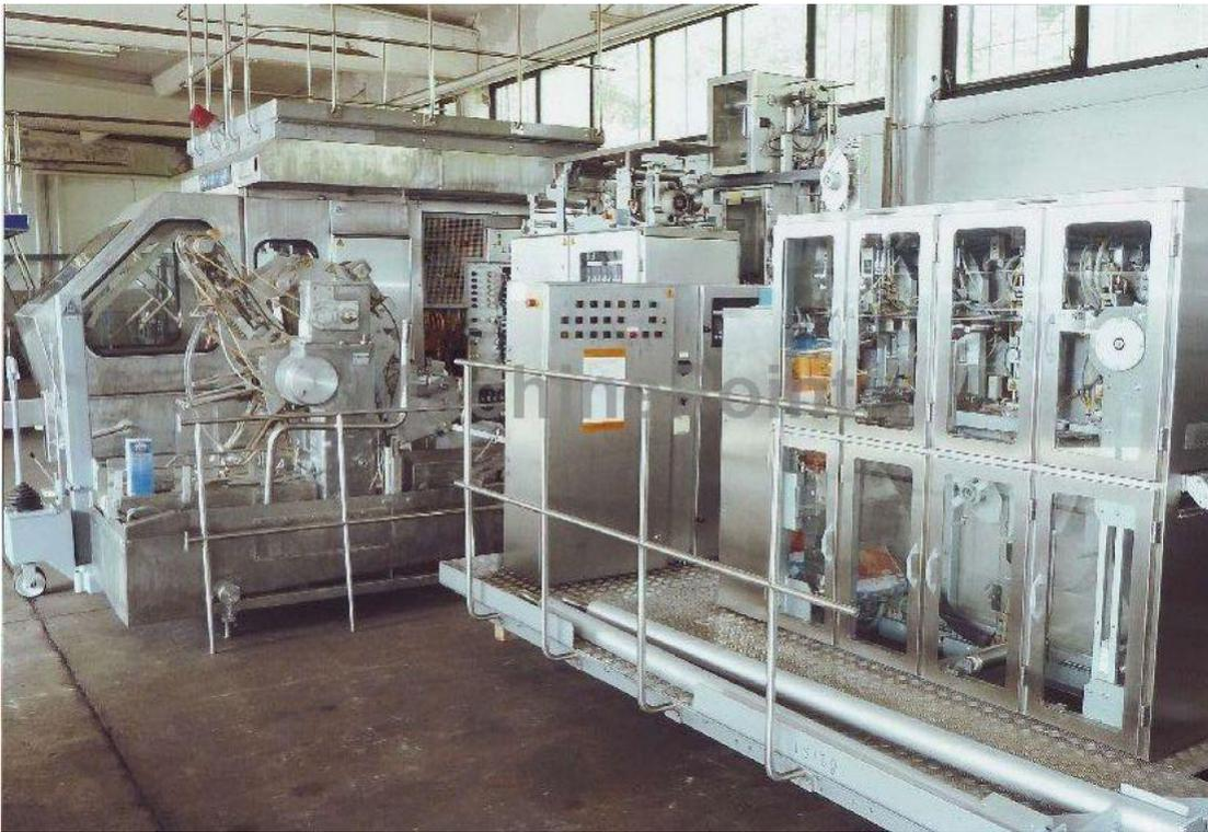
Abb. 3: TETRA PAK TBA8 Abfüllanlage
